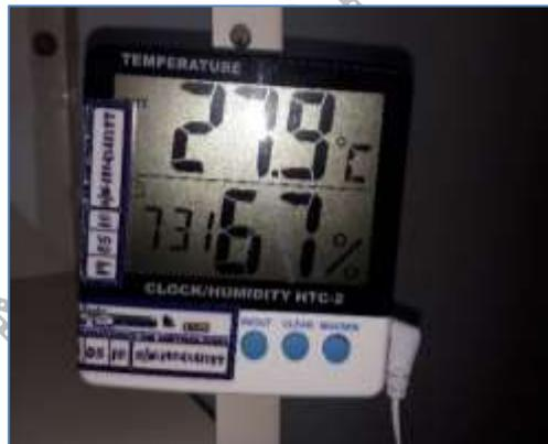
Para la toma de lecturas del porcentaje de humedad y grados de temperatura en áreas de archivo, se utiliza el Termo-higrómetro.
