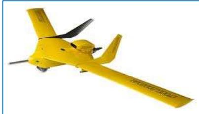
**Imagen 1.** Aeronave no tripulada para toma de fotografías aéreas
